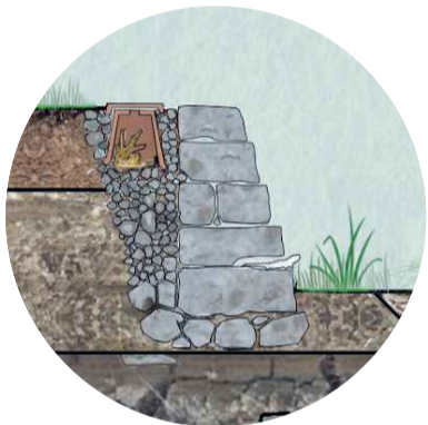
Trockenmauern und Hohlräume
