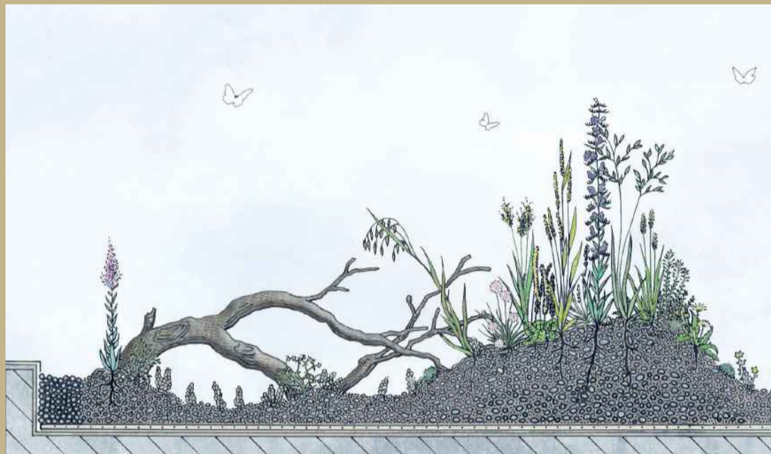
Schematischer Schnitt (nicht massstabgetreu) einer extensiven Dachbegrünung mit Mikrotopographie und Trockenholz für die Insekten.
