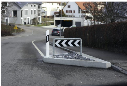
Abb. 11: Diverse Beispielbilder für Abweisblenden
